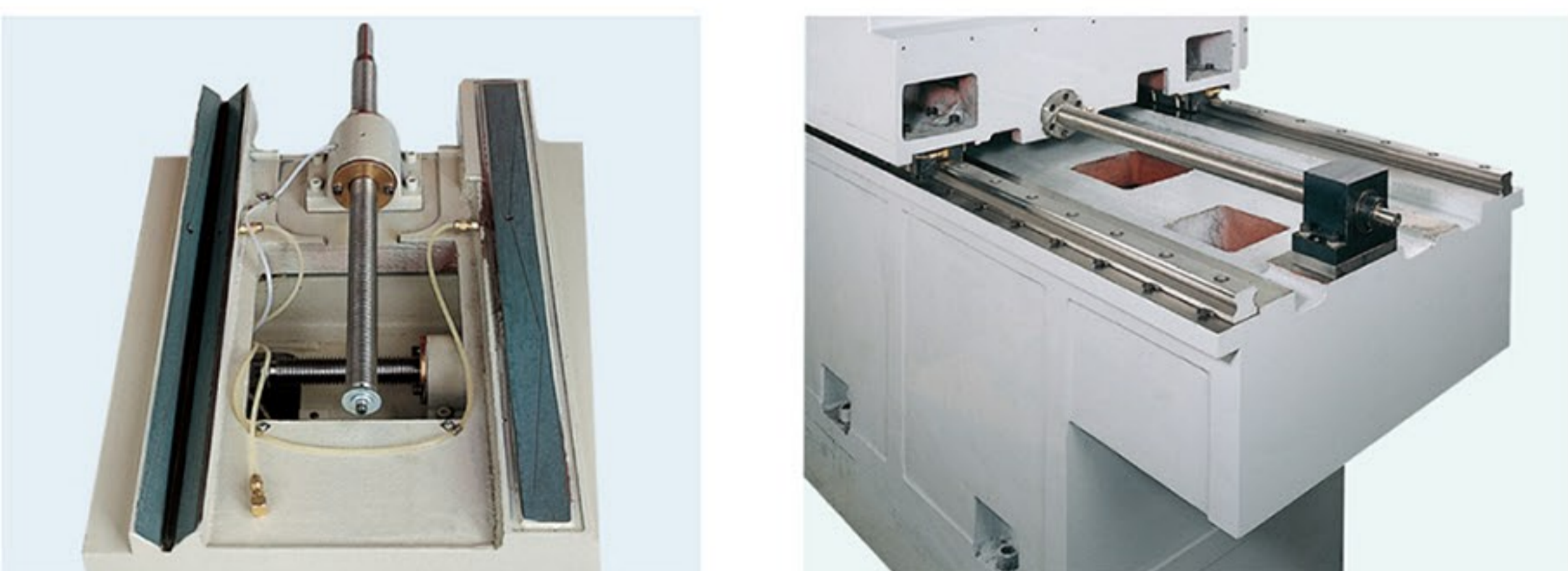
◆ V槽加平面滑道，並貼有鐵氟龍，耐磨、準確度高。
